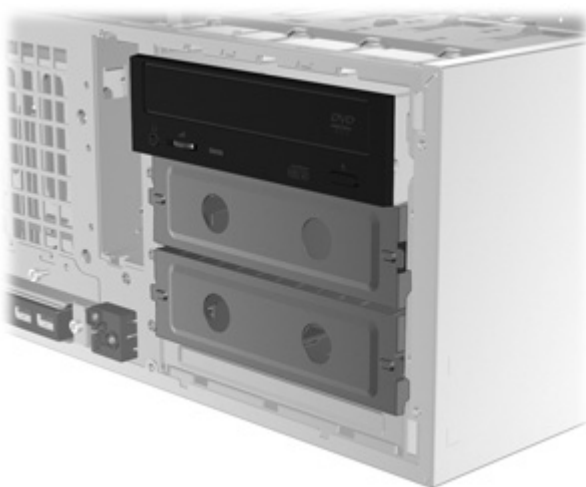
Rysunek 3-7 Ponowna instalacja napędu optycznego
