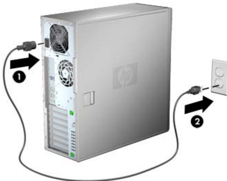
Rysunek 3-3 Podłączanie przewodu zasilającego
