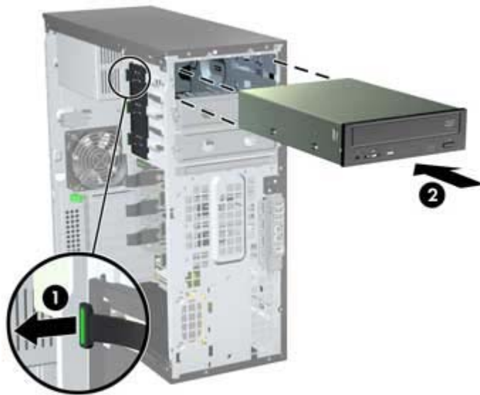
Rysunek 10-2 Wkładanie napędu do obudowy
