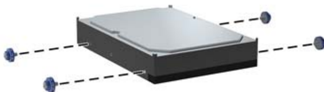
Rysunek 9-8 Instalacja wkrętów prowadzących dysku twardego
