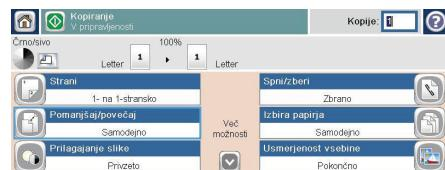
3. Izberite enega od vnaprej določenih odstotkov ali pa se dotaknite polja Prilagajanje velikosti in vnesite odstotek med 25 in 400. Dotaknite se gumba V redu. Izbirat lahko tudi med temi možnostmi:
