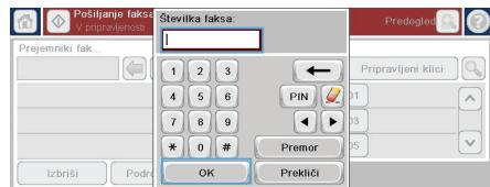
6. Dotaknite se ikone **Začni**, da pošljete faks. Lahko se dotaknete ikone **Začni** na zaslonu na dotik ali pritisnete **Začni** na nadzorni plošči.
