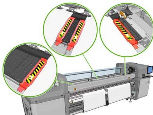
18. Entsperren Sie die Differentiale an den Eingangs- und Ausgangsspindeln.
