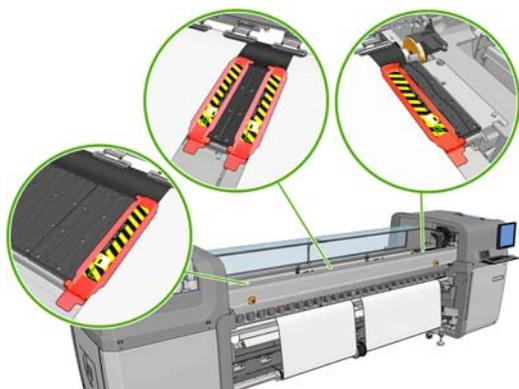
18. Déverrouillez les moyeux différentiels de la bobine d'entrée et de la bobine de sortie.
