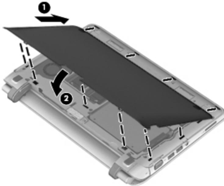
13. Empuje hacia abajo las partes derecha, central e izquierda de la cubierta de servicio hasta que todos los ganchos encajen en su lugar.
