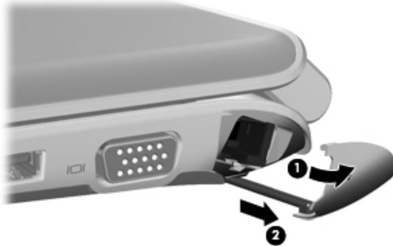
Para instalar la cubierta RJ-45:
