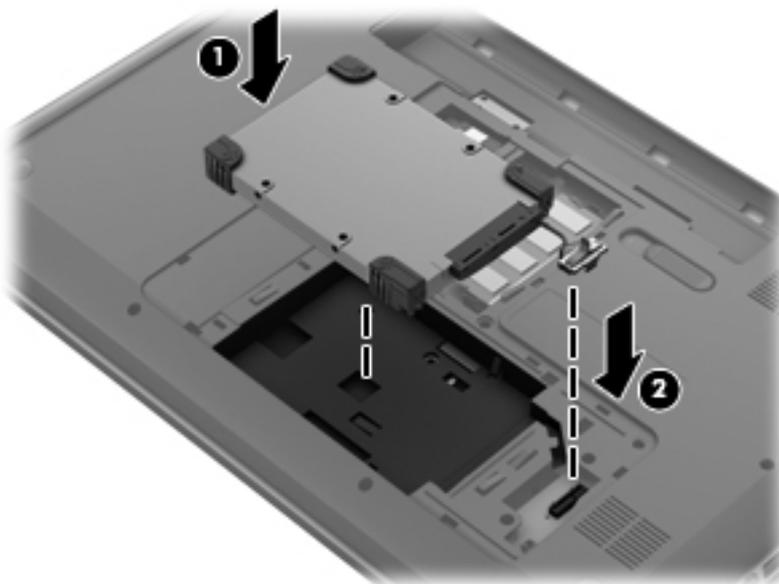
2. Richten Sie die Führungsnasen (1) der Service-Abdeckung an den Vertiefungen am Computer aus.
