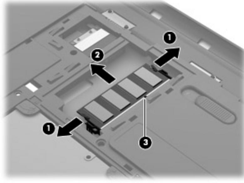
Bewahren Sie Speichermodule nach dem Entnehmen in einem elektrostatikgeschützten Behältnis auf.
