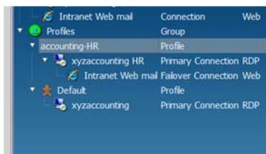
これで、xyzaccounting HR 接続のフェイルオーバー テストでその接続が使用できないことが判明した場合は常に、HPCM によってイントラネット Web メール クライアントが自動的に起動されます。また、フェイルオーバー接続に対するフェイルオーバー接続も設定できます。
