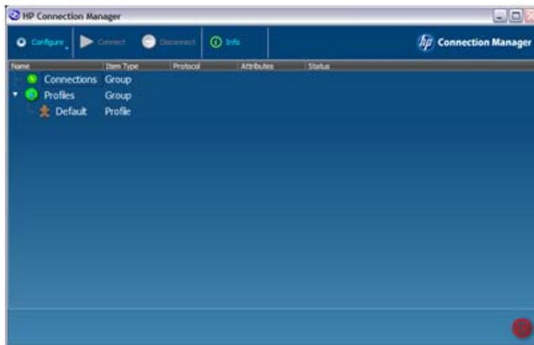
管理者モードの GUI には、ツールバー、[Connections] (接続) グループ ツリー、および [Profiles] (プロファイル) グループ ツリーが表示されます。また、初期設定のプロファイルも表示されます。定義した接続はすべて [Connections] ツリーに表示され、定義したプロファイルはすべて [Profiles] ツリーに表示されます。
