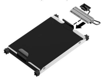
Insérez le disque dur (1) dans son compartiment, puis connectez le câble du disque dur (2) sur l'ordinateur.
