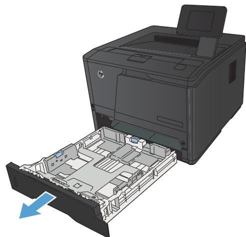
2. Deslice las guías longitudinales y horizontales del papel para abrirlas, presionando hacia fuera por las lengüetas azules.
