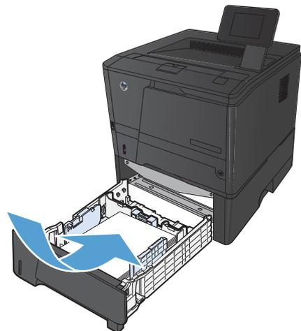
5. Presione el papel para comprobar que la pila se mantiene por debajo de las lengüetas limitadoras del papel que se encuentran en la parte trasera de la bandeja.
