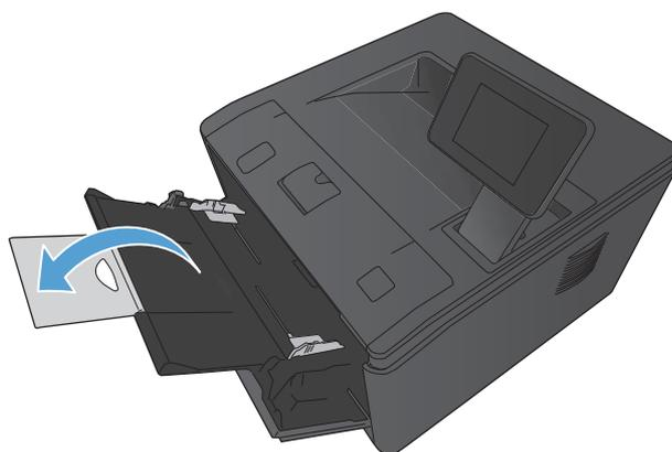
3. Coloque la pila de papel en la bandeja 1 y deslice las guías de papel de manera que se ajusten a las hojas.
