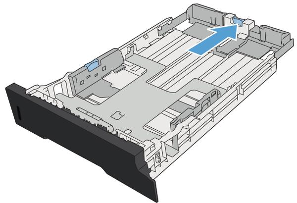
4. Coloque el papel en la bandeja y asegúrese de que queda liso en las cuatro esquinas. Deslice las guías de ancho y longitud del papel hasta que se ajusten a la pila de papel.
