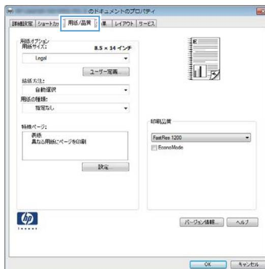
4. [異なる用紙にページを印刷] 項目をクリックし、[設定] ボタンをクリックして、表紙、他のページ、および裏表紙の必要な設定を選択します。
