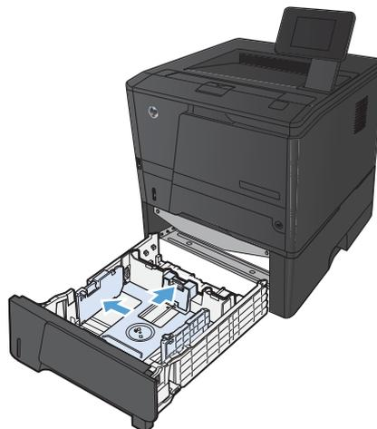
3. リーガル サイズの用紙をセットするには、トレイを延長します。延長するには、トレイの背面にあるリリース ボタンを押して、トレイの背面を外に引き出します。
