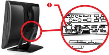
1. ケーブルをゲーム機等の機器接続用コネクタに接続して、オンスクリーンディスプレイを有効にします。
