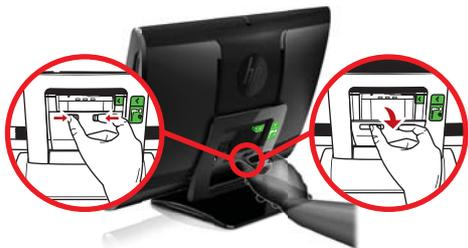
2. 背面のコンピュータースタンドの枠の内側にあるくぼみの右上隅の電源コネクターに電源コードを差し込みます。
