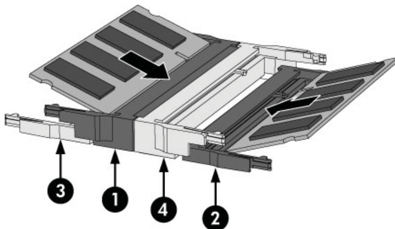
コンピューターに少なくとも 1 つのメモリモジュールが取り付けられていること、およびその 1 つが黒のスロットに取り付けられていることを確認します
