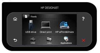
前面板有一大块中央区域,可用以显示动态信息和图标。在左右两侧,您可以在不同情况下看到最多 6 个固定图标。通常情况下,它们不会同时显示。
