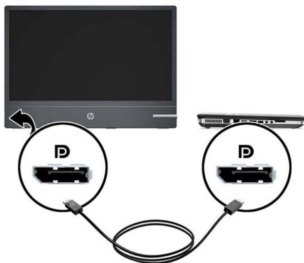
Εικόνα 3-3 Σύνδεση του καλωδίου DisplayPort
