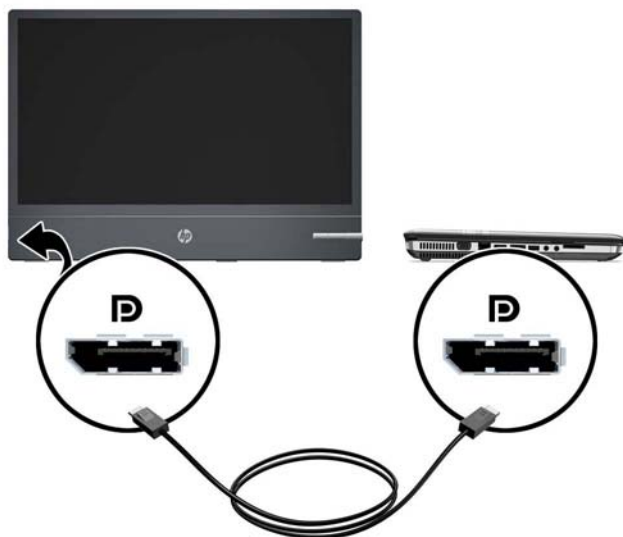
図 3-3 DisplayPort ケーブルの接続
