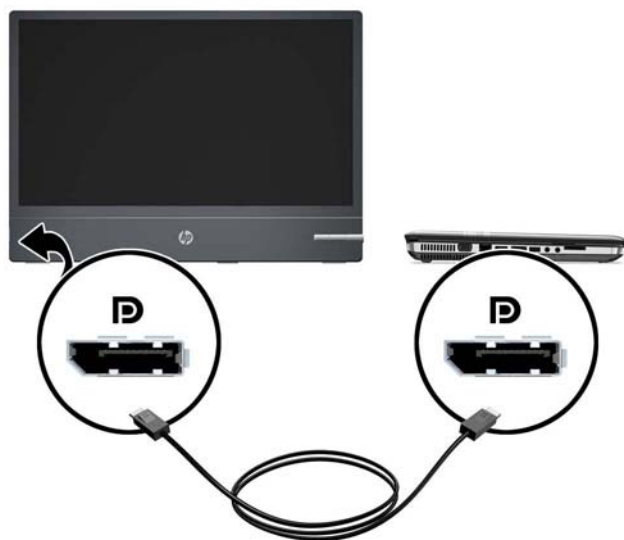
图 3-3 连接 DisplayPort 电缆
