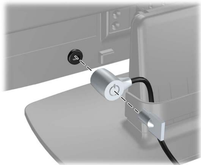
Figure 3-10 Installation d'un dispositif antivol
