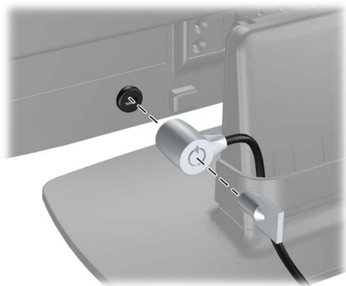
Figura 3-10 Installazione della chiusura con cavo
