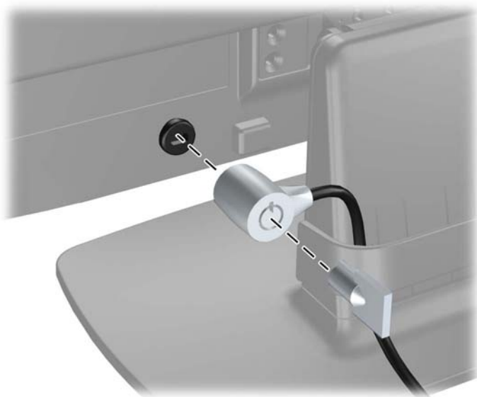
Gambar 3-10 Memasang Kunci Kabel
