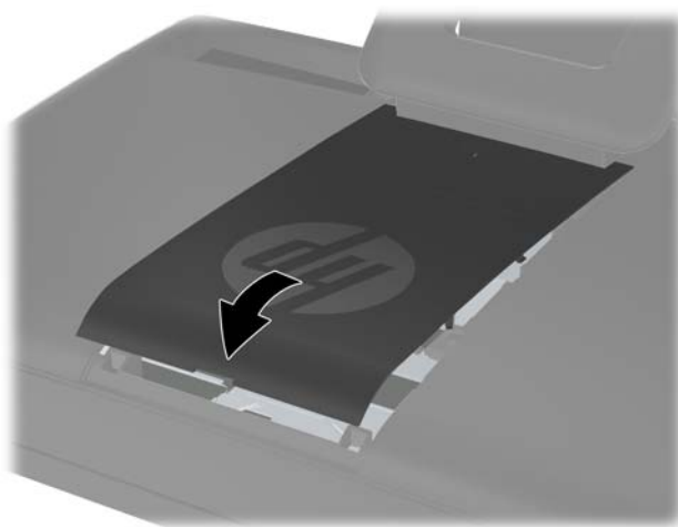
Εικόνα 2-9 Επανατοποθέτηση καλύμματος κεντρικής πρόσβασης
