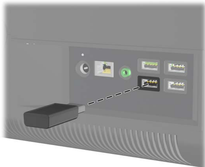
Rysunek 2-23 Instalacja odbiornika bezprzewodowego
