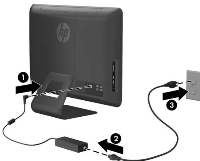
Rysunek 2-1 Podłączanie zasilania
