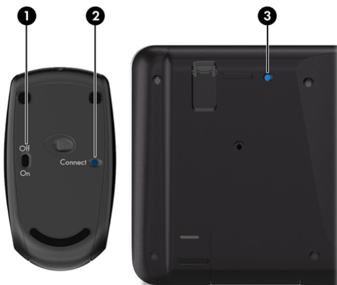
Rysunek 2-24 Synchronizowanie bezprzewodowej klawiatury i myszy
