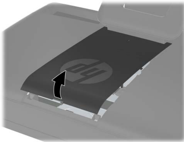
Rysunek 2-2 Zdejmowanie panelu środkowego
