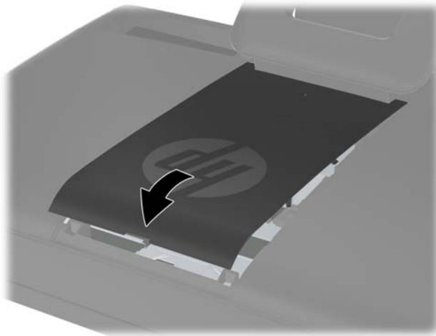
Gambar 2-9 Memasang Kembali Panel Akses Tengah
