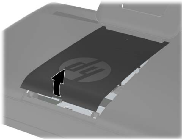
Gambar 2-10 Melepaskan Panel Akses Tengah
