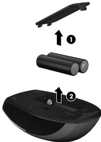
Gambar 2-26 Melepas Baterai dari Mouse Nirkabel
