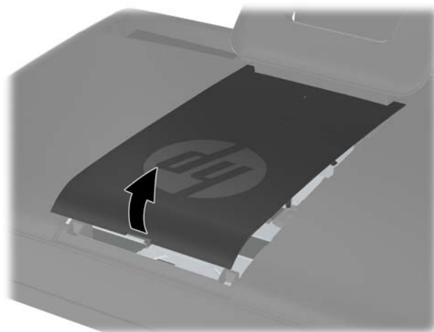
Gambar 2-2 Melepaskan Panel Akses Tengah
