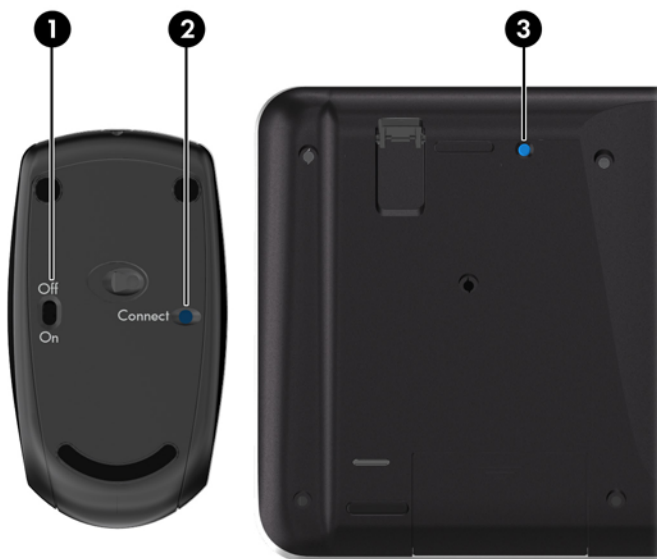
Gambar 2-24 Menyinkronkan Mouse dan Keyboard Nirkabel
