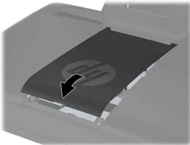
Gambar 2-21 Memasang Kembali Panel Akses Tengah
