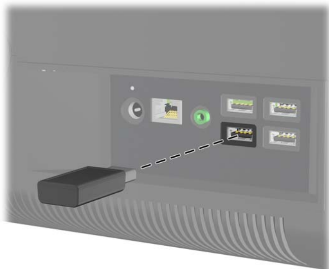
Joonis 2-23 Juhtmevaba vastuvõtja paigaldamine
