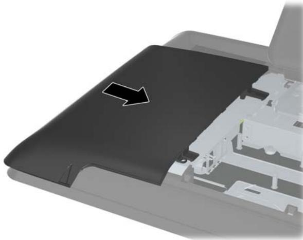
13. Para reemplazar el panel de acceso central, inserte el borde inferior del panel y pulse con fuerza hacia abajo a cada lado del panel de abajo a arriba para que el panel se coloque en su sitio.
