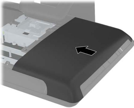
17. Para reemplazar el panel de acceso central, inserte el borde inferior del panel y pulse con fuerza hacia abajo a cada lado del panel de abajo a arriba para que el panel se coloque en su sitio.
