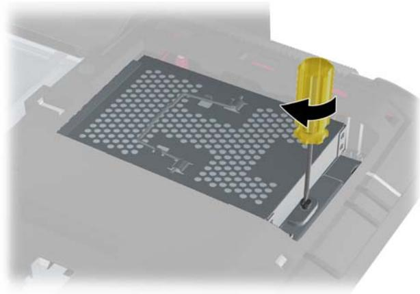
16. Coloque el panel de acceso de la unidad en la parte trasera del equipo de manera que el borde del panel penda ligeramente en el borde del equipo, y desplace el panel hacia el equipo hasta que se coloque en su sitio.
