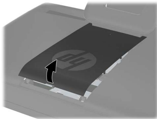
7. Para extraer el panel de acceso a la memoria, tire hacia arriba de las dos pestañas en el borde interior del panel (1) y deslícelo hacia fuera (2).
