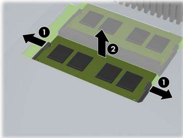
10. Para instalar un módulo de memoria, deslice el nuevo SODIMM en el hueco en un ángulo de aproximadamente 30° grados (1) luego presione el SODIMM hacia abajo (2) para que encaje en su lugar.
