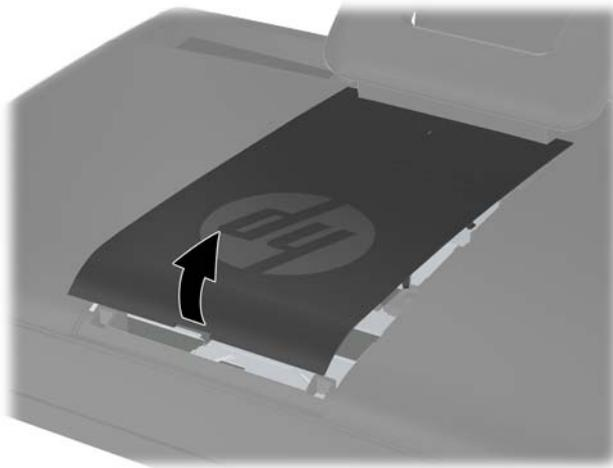
7. Para extraer el panel de acceso a la unidad, tire hacia abajo de las dos pestañas en el borde interior del panel (1) y deslícelo hacia fuera (2).
