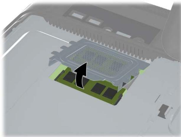
9. Para extraer un módulo de memoria, presione hacia fuera los dos pestillos en cada lado del SODIMM (1) y luego extraiga el SODIMM hacia fuera del hueco (2).
