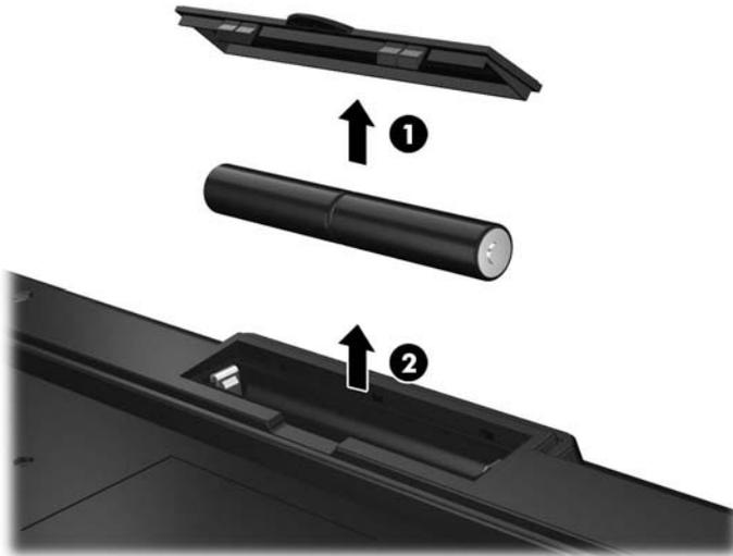
Para extraer pilas de un ratón inalámbrico quite la tapa para las baterías en la parte inferior del ratón (1) y extraiga las pilas de su compartimento (2).
