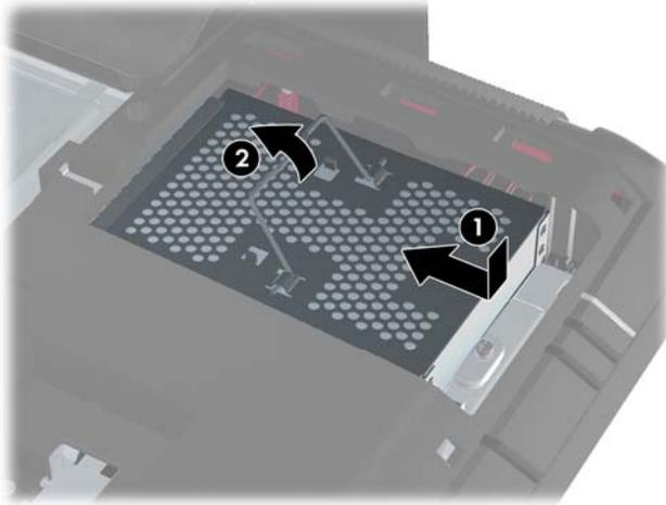
15. Fije el tornillo de sujeción para asegurar la carcasa de la unidad de disco duro. Puede usar un destornillador Torx o de punta plana para asegurar el tornillo.
