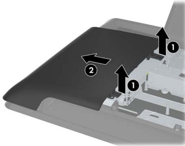
8. Tire hacia arriba de las dos pestañas elevadas en la cubierta de memoria y levántela del panel trasero.
