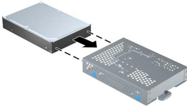
13. Monte los cuatro tornillos que fijan la unidad de disco duro a la carcasa. Asegúrese de que los ojales azules de goma permanecen pegados a la carcasa detrás de cada tornillo.
