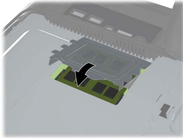
12. Coloque el panel de acceso de memoria en la parte trasera del equipo de manera que el borde del panel penda ligeramente en el borde del equipo, y desplace el panel hacia el equipo hasta que se coloque en su sitio.
