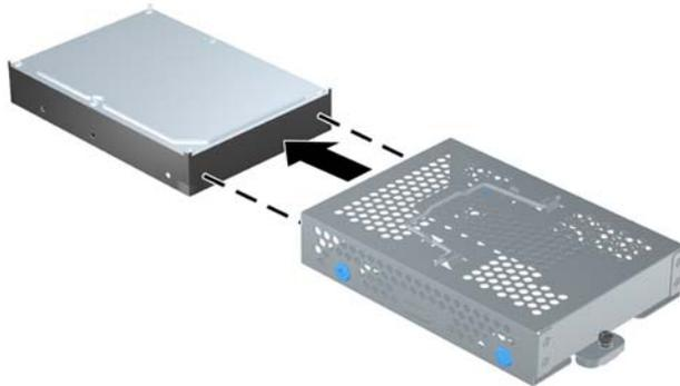
12. Deslice el nuevo disco duro dentro de la carcasa; asegúrese de que los conectores del disco duro estén en la abertura de la carcasa.
