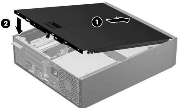
15. Schließen Sie das Netzkabel und die externen Geräte ggf. wieder an, und schalten Sie den Computer ein.
