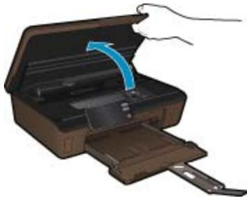
Warten Sie, bis sich der Patronenwagen im Bereich mit den Tintenetiketten im Produkt befindet.
