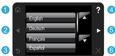
Gumbi na nadzorni plošči so osvetljeni le, ko so na voljo.
