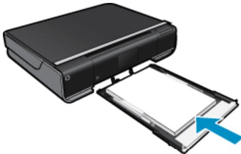
Legen Sie den Papierstapel mit der schmalen Kante nach vorne und der zu bedruckenden Seite nach unten in die Mitte des Papierfachs ein. Schieben Sie den Stapel im Fach bis zum Anschlag nach vorne. Schieben Sie die Papierquerführungen nach innen bis an die Papierkanten heran. Schließen Sie das Papierfach.
