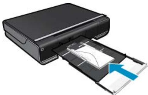
Inserte la pila de sobres en el centro de la bandeja de papel con el borde corto primero y la cara de impresión hacia abajo. Presione la pila hacia delante dentro de la bandeja por completo.
