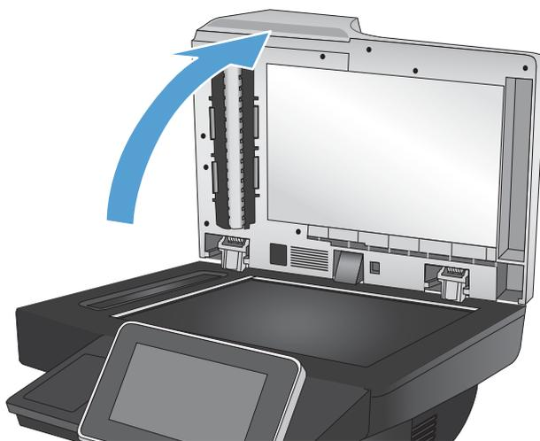
3. メインスキャナガラス板、文書フィーダのガラス板（スキャナの左側にある細いガラス）、白い裏張り部分をクリーニングします。柔らかい布またはスポンジに研磨剤の入っていないガラスクリーナーを湿らせて使用します。しみを防ぐには、セーム革またはセルローススポンジでガラスと白いプラスチックの裏板を拭きます。
