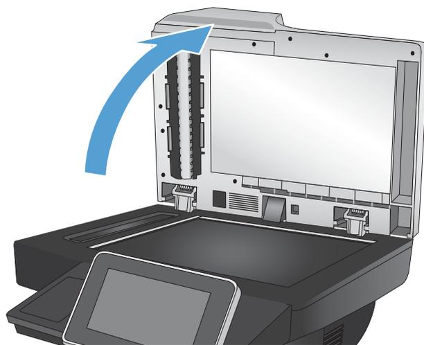
3. メインスキャナのガラス板、文書フィーダのガラス板(スキャナの左側にある細いガラス)、白い裏張り部分をクリーニングします。柔らかい布またはスポンジに研磨剤の入っていないガラスクリーナーを湿らせて使用します。しみを防ぐには、セーム革またはセルローススポンジでガラスと白いプラスチックの裏板を拭きます。
