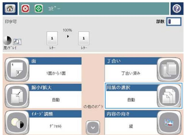
3. 使用する用紙がセットされているトレイを選択し、[OK] ボタンをタッチします。
