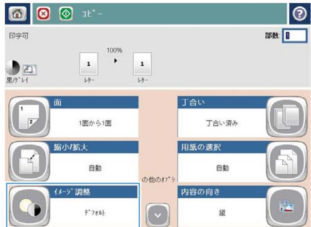
3. [濃さ]、[コントラスト]、[鮮明度]、[背景のクリーンアップ]の各スライダを動かしてレベルを調整します。[OK] ボタンをタッチします。
