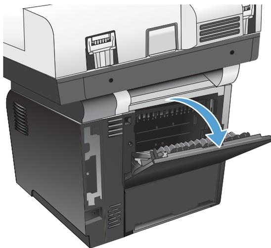
**注記：**後部排紙ビンを開くと、両面印刷ユニットと上部排紙ビンが使用できなくなります。紙詰まりを避けるため、印刷中に後部排紙ビンを開閉しないでください。
