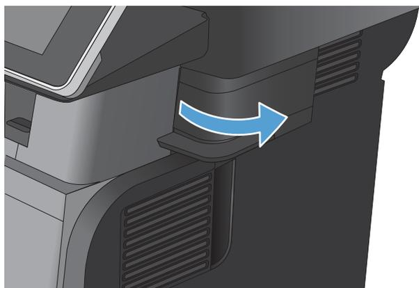
2. ステイプル カートリッジを交換する場合 (ステイプル カートリッジのステイプルがなくなった場合など)、プリンタからステイプル カートリッジを取り外します。
