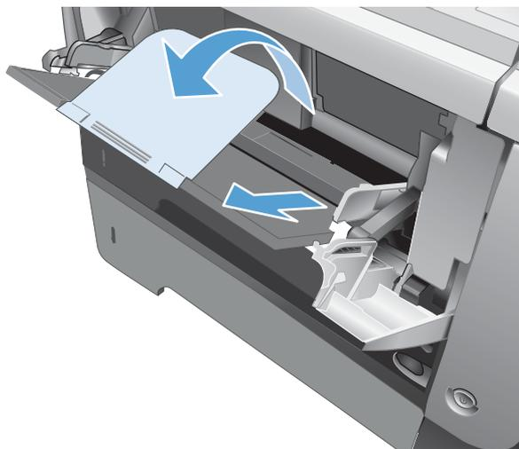
3. トレイに用紙をセットします。用紙がタブの下に収まっており、最大許容枚数インジケータを超えていないことを確認します。
