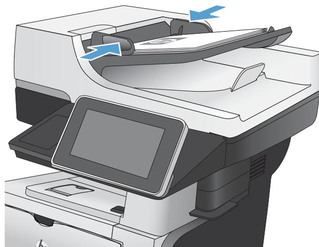
2. プリンタのコントロールパネルのホーム画面で、[デバイス メモリに保存] ボタンまでスクロールしてタッチします。
