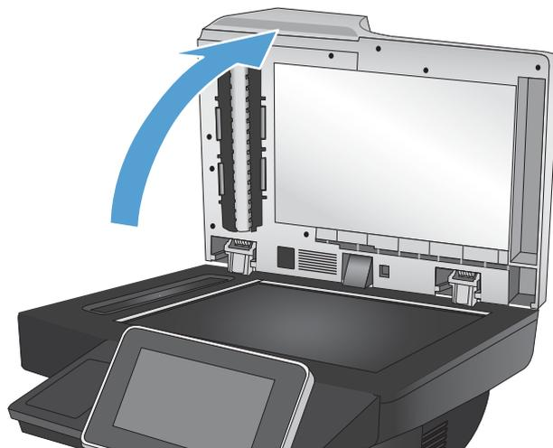
2. 写真の左上角をスキャナのガラス板の左上角に合わせ、下向きにしてのせます。
