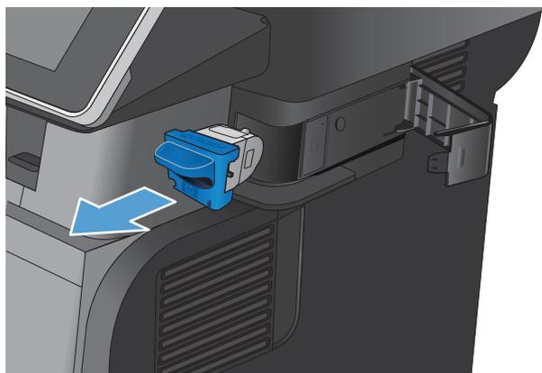
3. ステイプラのドアの内側にある開口部に新しいステイプルカートリッジを挿入します。
