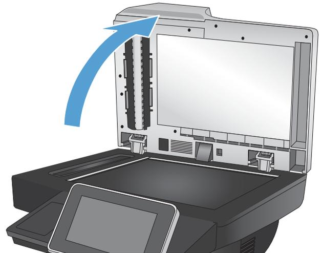
2. 文書を下向きにしてスキャナのガラス面に置きます。ページの左上端は、スキャナのガラス面の左上端に合わせます。
