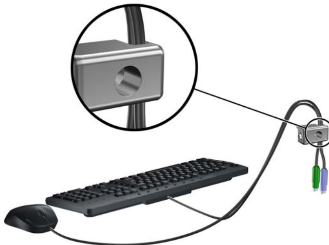
Figura 2-31 Passaggio dei cavi della tastiera e del mouse
