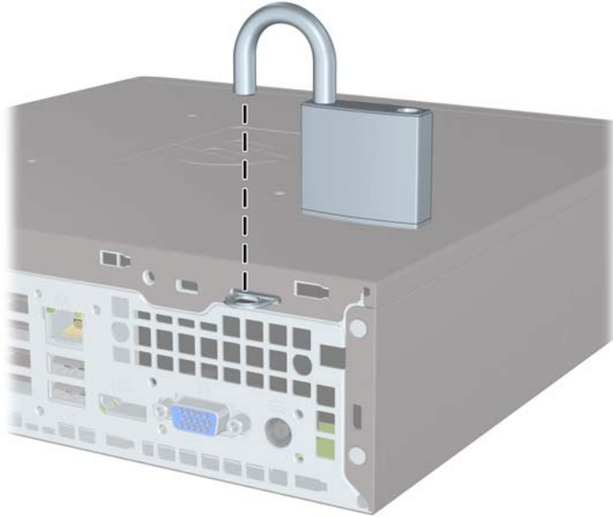
Figura 2-26 Installazione di un lucchetto
