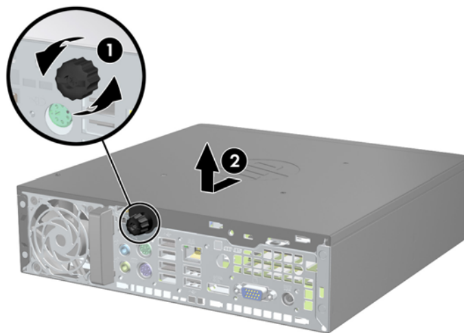
Figura 2-2 Rimozione del pannello di accesso al computer
