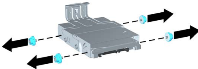
Figura 2-17 Rimozione delle viti guida
