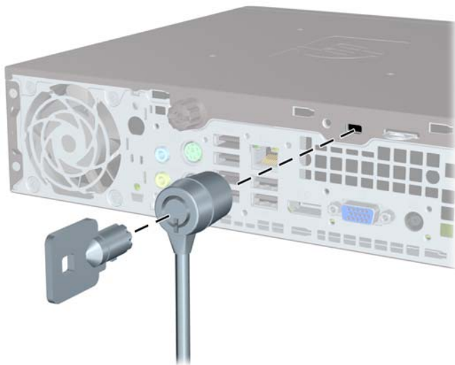
Figura 2-25 Installazione di un cavo con coperchio della porta installato
