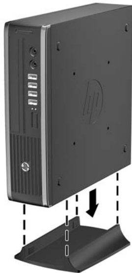
Figura 2-7 Inserire il computer nella base
