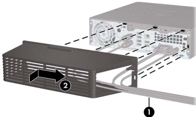
Figura 2-22 Installazione di un coperchio della porta
