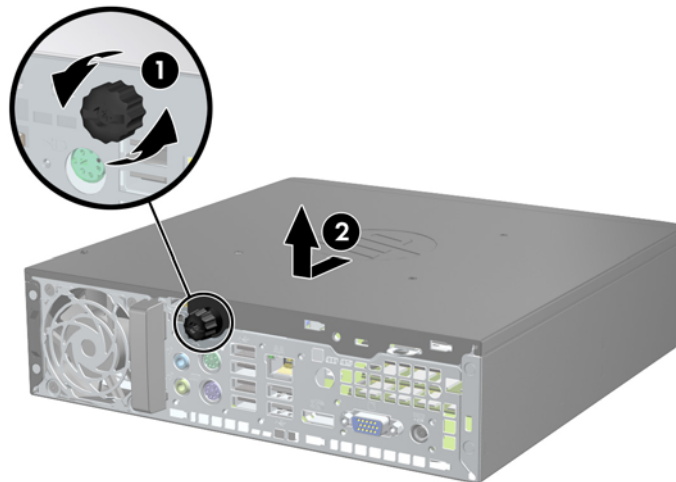
Rysunek 2-2 Zdejmowanie panelu dostępu komputera
