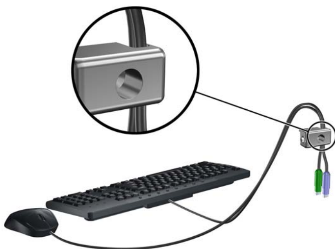
Rysunek 2-31 Przewlekanie kabli klawiatury i myszy
