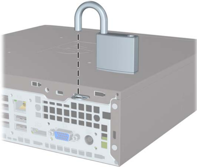
Figura 2-26 Instalación de un candado
