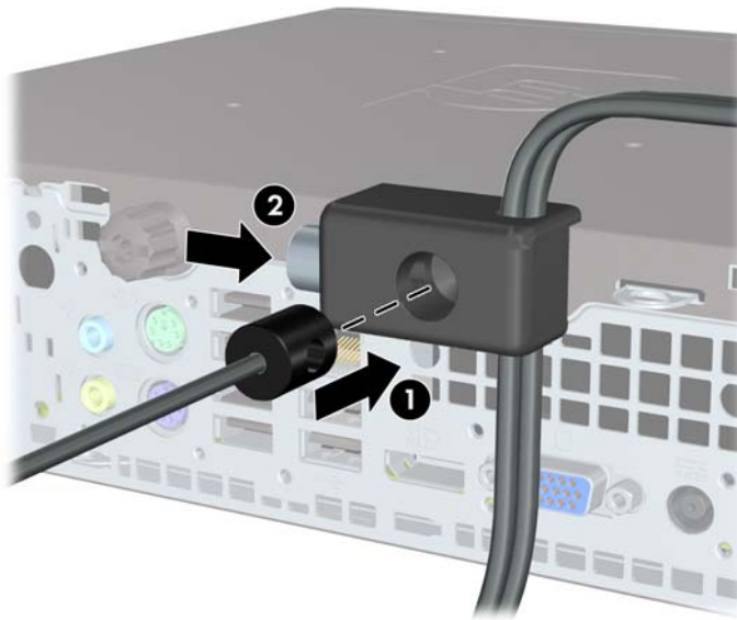
Figura 2-33 Activación del bloqueo
