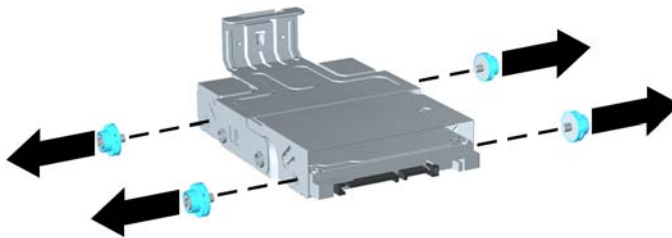
Figura 2-17 Extracción de los tornillos guía
