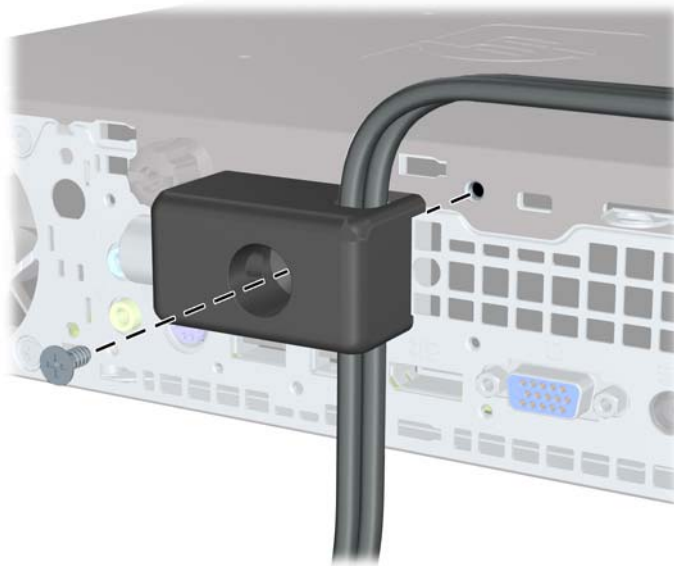
Figura 2-32 Acoplado del bloqueo al chasis
