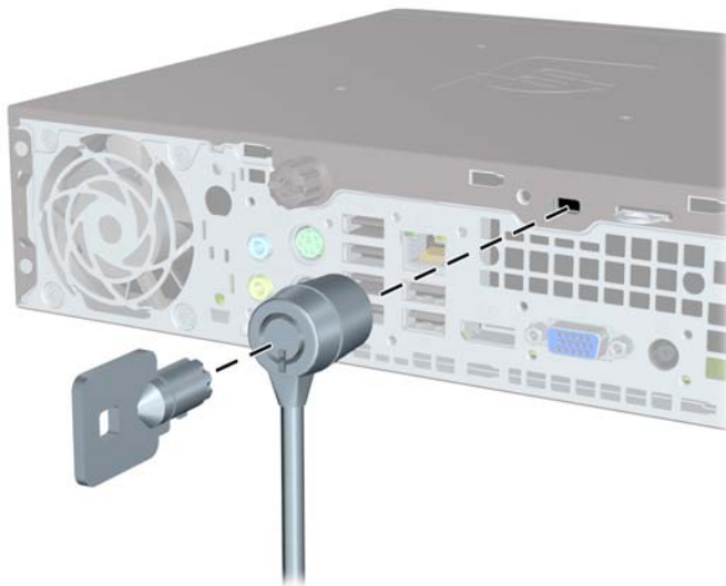
Figura 2-24 Instalación de un bloqueo de cable sin cubierta para puerto
