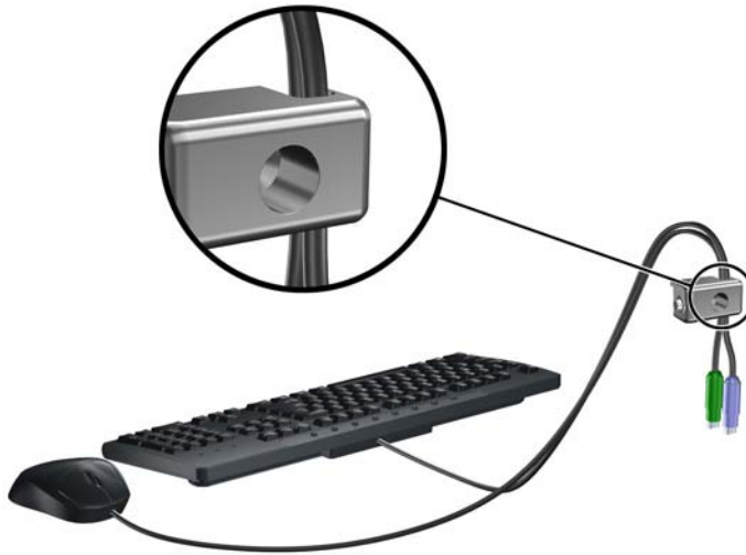
Figura 2-31 Enroscado de los cables del teclado y del mouse
