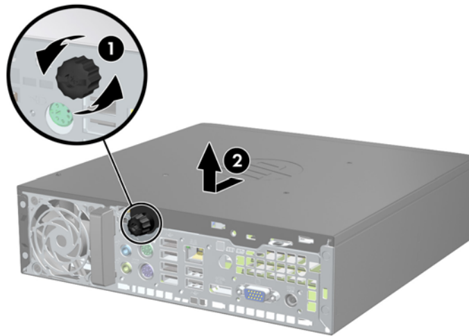
Figura 2-2 Extracción del panel de acceso del equipo
