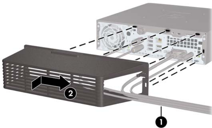
Figura 2-22 Instalación de una cubierta para puerto
