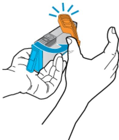
c. 比较颜色图标，然后将墨盒向插槽内滑动，直到碰触到位。
