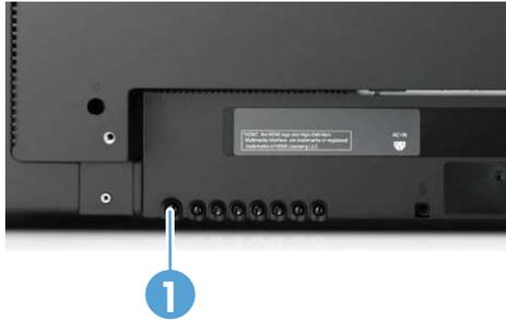
**Abbildung 3-25** HP LD4720tm - Netzschalter
