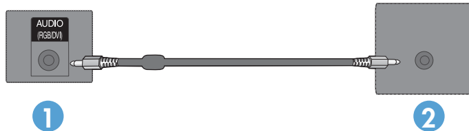
Gambar 3-21 Menghubungkan kabel audio
