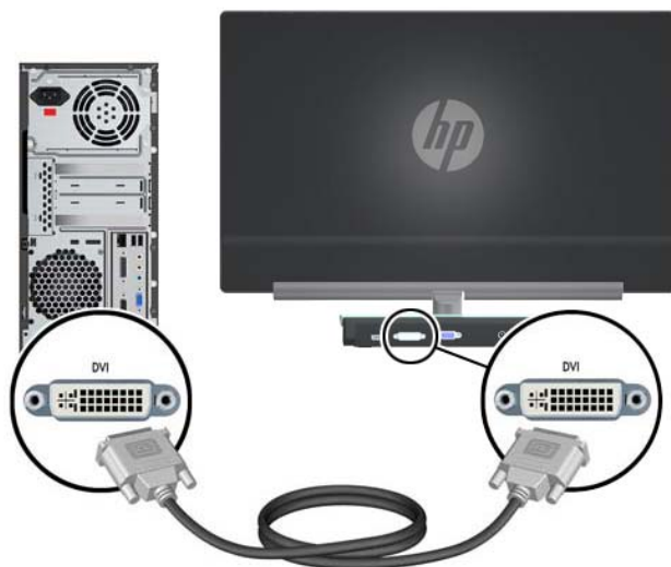
Figure 3-1 Branchement du câble DVI-D
