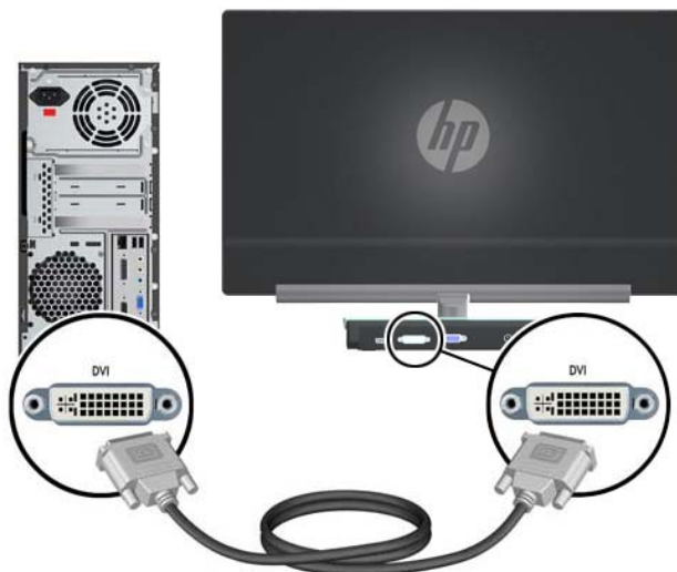
Figura 3-1 Conexión del cable DVI-D
