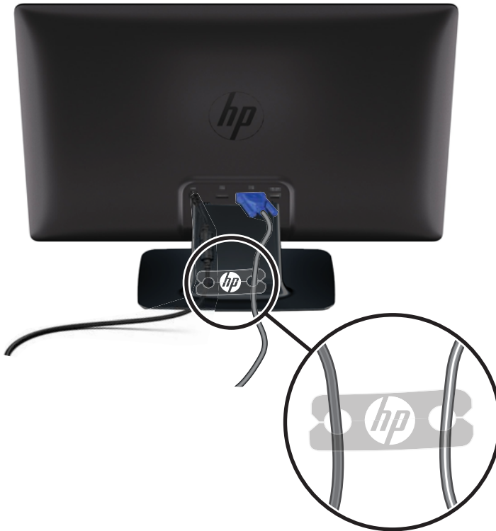
Figura 3-7 Installazione della clip raccogli cavi
