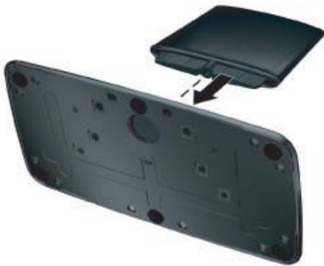
Figura 3-1 Montaggio della base e del piedistallo
