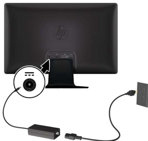
Figura 3-6 Collegamento del cavo di alimentazione
