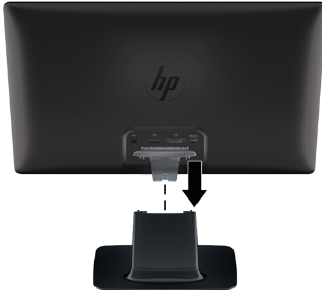
Figura 3-2 Inserimento del pannello del monitor
