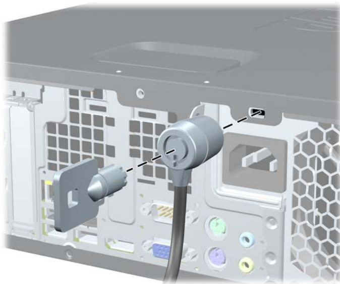
Abbildung C-1 Anbringen einer Kabel-Diebstahlsicherung
