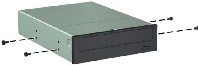
Abbildung 2-22 Installieren von Führungsschrauben am optischen Laufwerk
