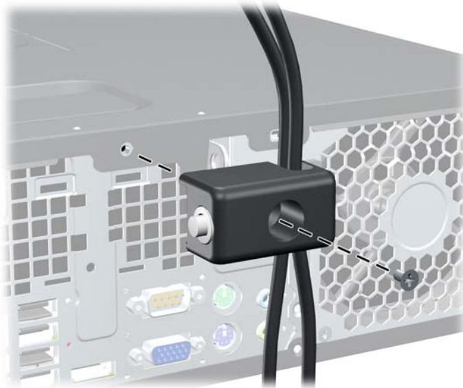
Abbildung C-8 Befestigen der Sperre am Gehäuse
