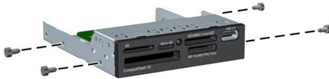
Abbildung 2-29 Anbringen von Führungsschrauben (Speicherkarten-Lesegerät abgebildet)
