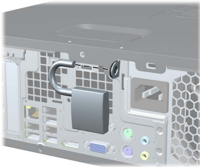
Abbildung C-2 Anbringen eines Vorhängeschlosses
