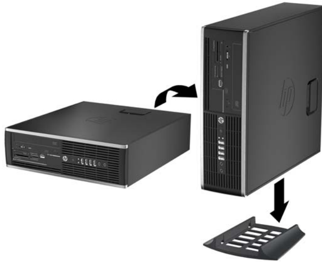
Abbildung 2-6 Umwandeln des Desktop-Systems in ein Tower-System
