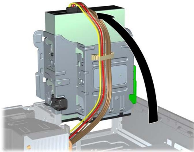
8. Redressez le bloc d'alimentation en le faisant pivoter. Le disque dur se trouve sous le bloc d'alimentation.
