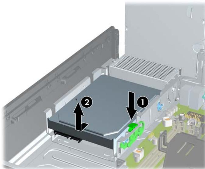
11. Pour installer un disque dur, vous devez retirer les quatre vis de guidage d'isolation argentées et bleues de l'ancien disque dur et les installer sur le nouveau disque dur.
