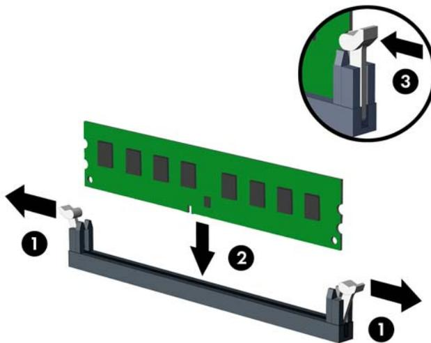
**REMARQUE :** Un module mémoire ne peut être installé que d'une seule façon. Faites coïncider l'encoche située sur le module avec la patte du support de mémoire.
