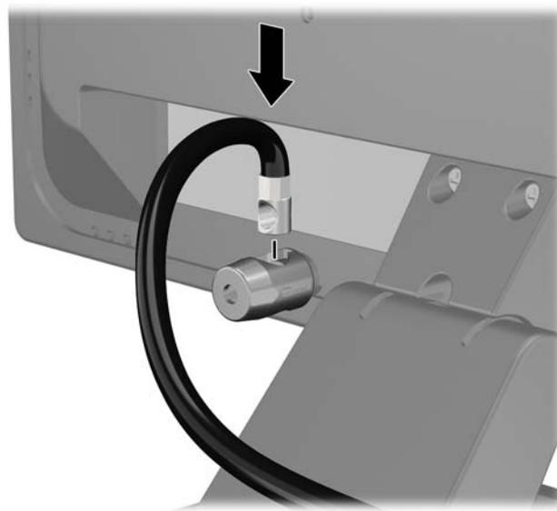
4. Utilisez le support de montage fourni dans le kit pour sécuriser d'autres unités périphériques en introduisant le câble du périphérique dans le centre du support (1) et en insérant le câble de sécurité dans l'un des deux trous du support de montage (2). Utilisez le trou du support de montage sécurisant le mieux le câble de l'unité périphérique.
