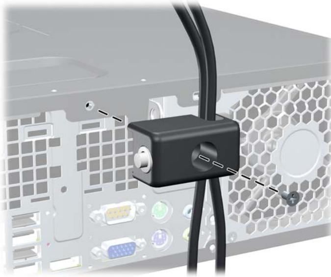
7. Insérez le côté prise du câble de sécurité dans le verrou (1) et poussez le bouton (2) pour engager le verrou. Utilisez la clé fournie pour désengager le verrou.
