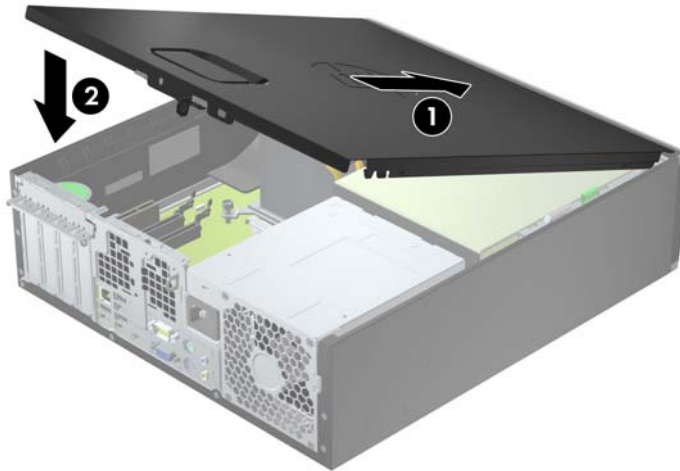
Figura 2-2 Reinstalação do painel de acesso do computador
