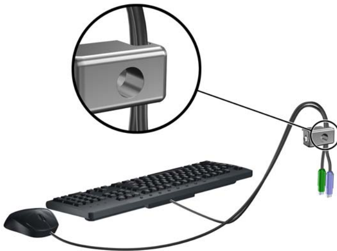
Figura C-7 Organização dos Cabos do Teclado e Mouse
