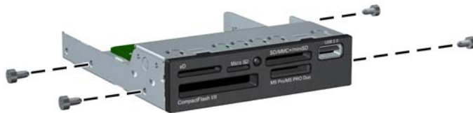
図 2-29 ガイド用ネジの取り付け (図はメディア カード リーダー)
