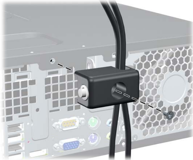
図 C-8 シャーシへの錠の取り付け
