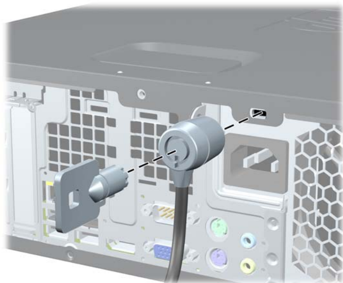
図 C-1 ロック ケーブルの取り付け
