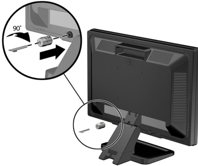
3. 将安全电缆穿过显示器背面的 Kensington 锁中的孔。
