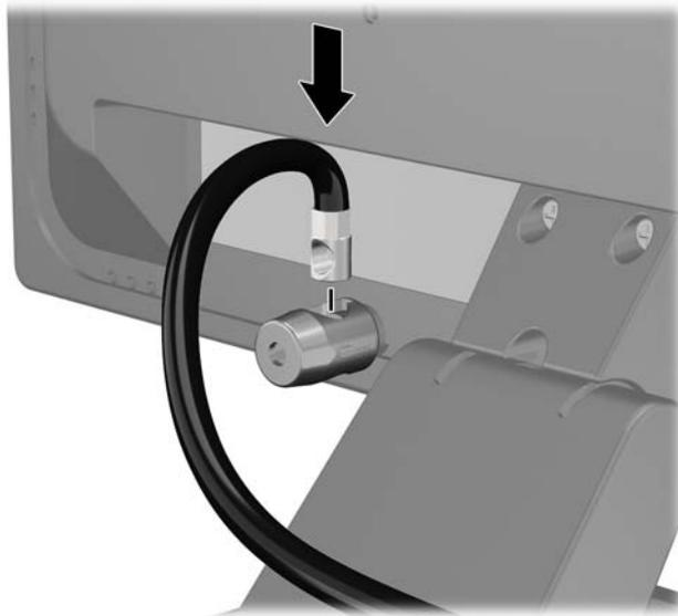
4. 使用包装中附带的电缆架固定其他外设，方法是将设备电缆穿过电缆架中心 (1)，将安全电缆插入电缆架的两个孔之一 (2)。使用电缆架中能够最牢固地固定外设电缆的孔。
