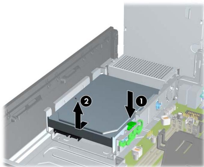
11. 要安装硬盘驱动器，您必须将旧硬盘驱动器上的银蓝色绝缘安装导向螺钉装到新硬盘驱动器上。
