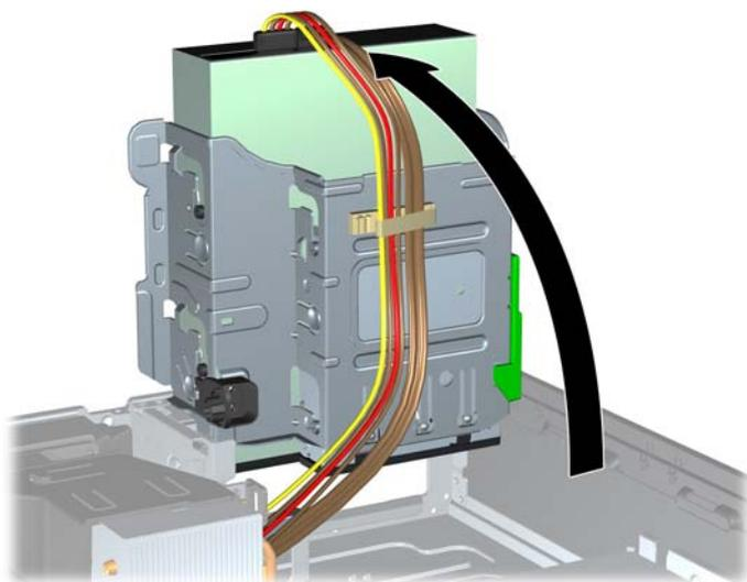
8. 如果要卸下光驱，请从光驱背面断开电源电缆 (1) 和数据电缆 (2)。
