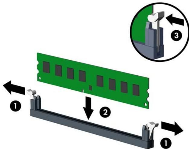
**注：** 内存模块只能以一种方式安装。使内存模块上的凹口与插槽上的凸起对齐。
