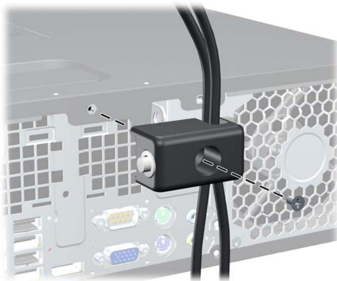
7. 将安全保护缆锁一端的插头插入钳锁中 (1)，然后按 (2) 所示方向推按钮以锁上钳锁。使用附带的钥匙可以打开该锁。
