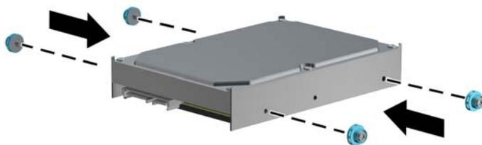
12. 将导向螺钉对准机箱驱动器框架上的插槽，并向下按硬盘驱动器使其进入托架，然后向后滑动驱动器直到滑不动且锁定到位为止。
