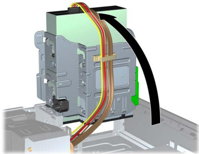
8. 将电源旋转到垂直位置。硬盘驱动器位于电源的下方。
