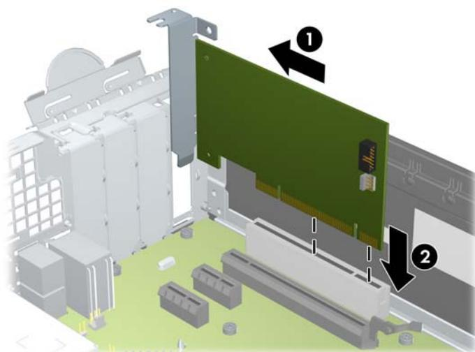
**注** 安装扩展卡时，请用力按压扩展卡，以使整个连接器在扩展卡插槽中正确就位。
