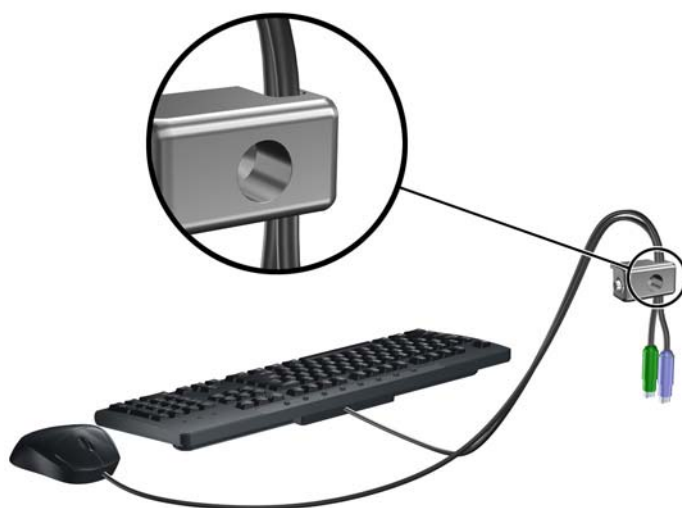
圖示 C-7 穿過鍵盤及滑鼠纜線
