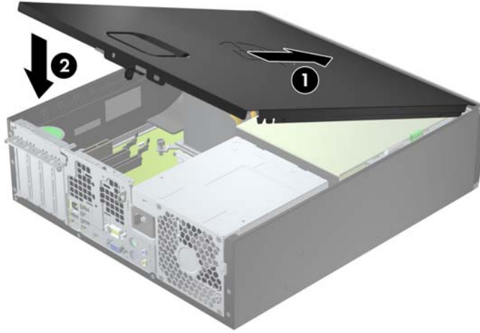
圖示 2-2 裝回電腦存取面板
