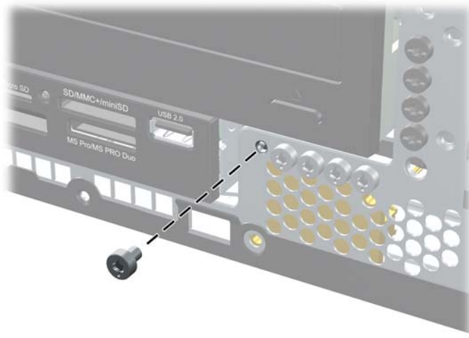
Figura C-11 Extracción del tornillo de seguridad del panel frontal
