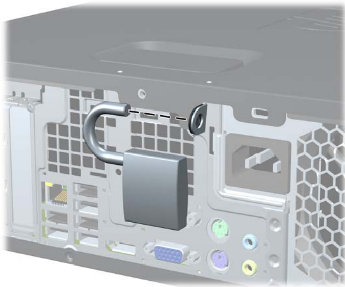
Figura C-2 Instalación de un candado
