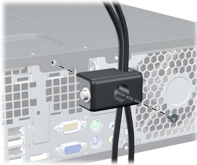
Figura C-8 Acoplado del bloqueo al chasis
