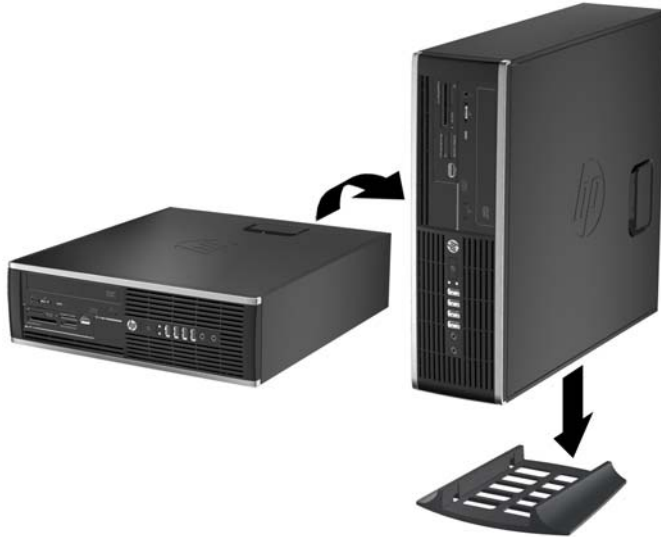
Figura 2-6 Cambio de configuración de desktop para torre
