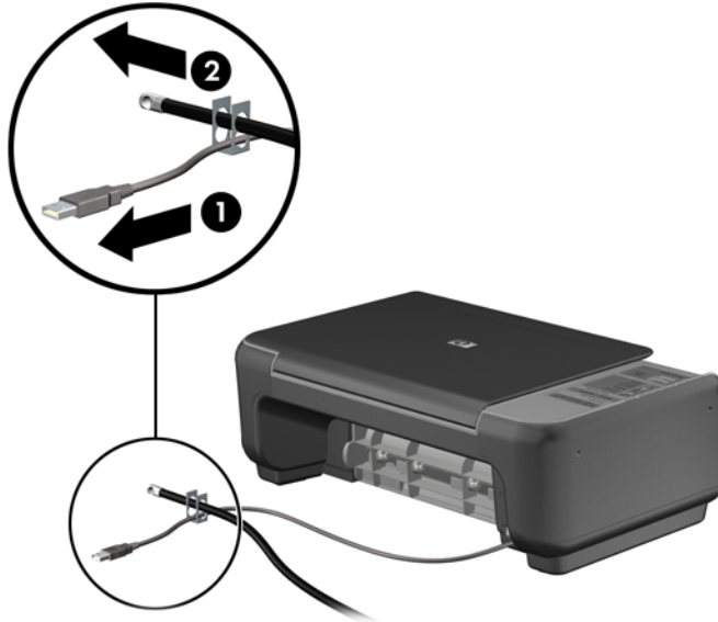
Figura C-6 Fijación de dispositivos periféricos (se muestra la impresora)
