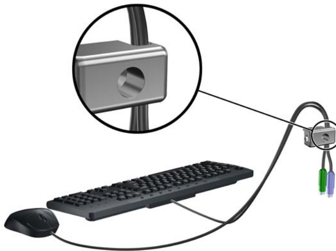
Figura C-7 Enroscado de los cables del teclado y del mouse
