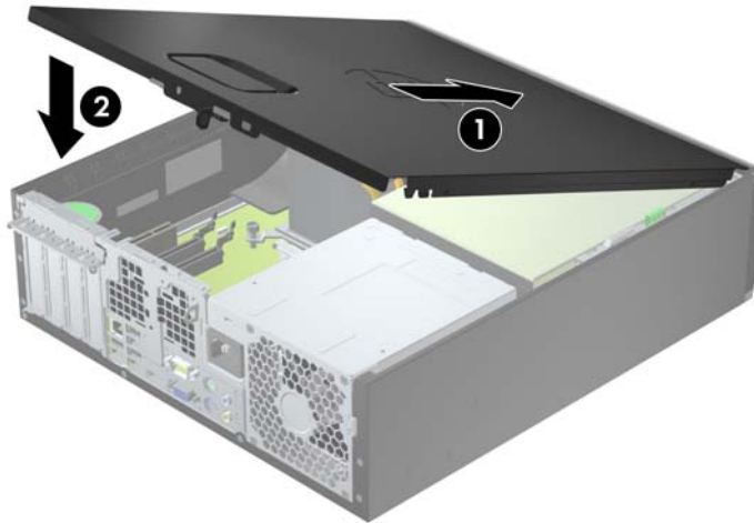
Figura 2-2 Reinstalación del panel de acceso del equipo
