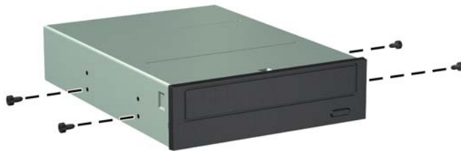
Figura 2-22 Instalación de tornillos guía en la unidad óptica
