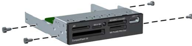
Figura 2-29 Instalación de tornillos guía (se muestra un lector de tarjetas multimedia)
