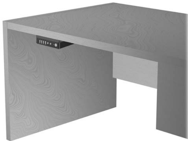
図 C-6 机の下に取り付けられた t200 Zero Client
