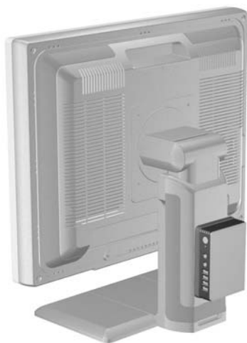
図 C-3 モニター スタンドの背面に取り付けられた t200 Zero Client
