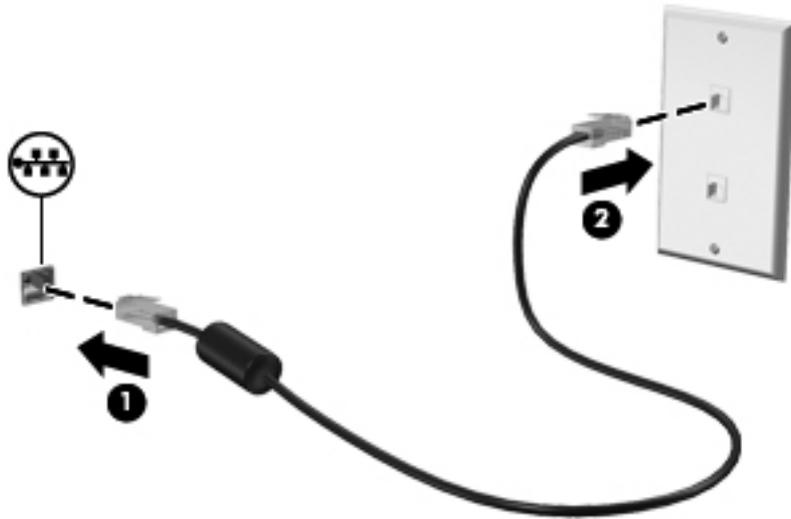
⚠ **警告！** 為降低電擊、火災或損壞設備的風險，請勿將數據機或電話線插入 RJ-45（網路）接頭。
