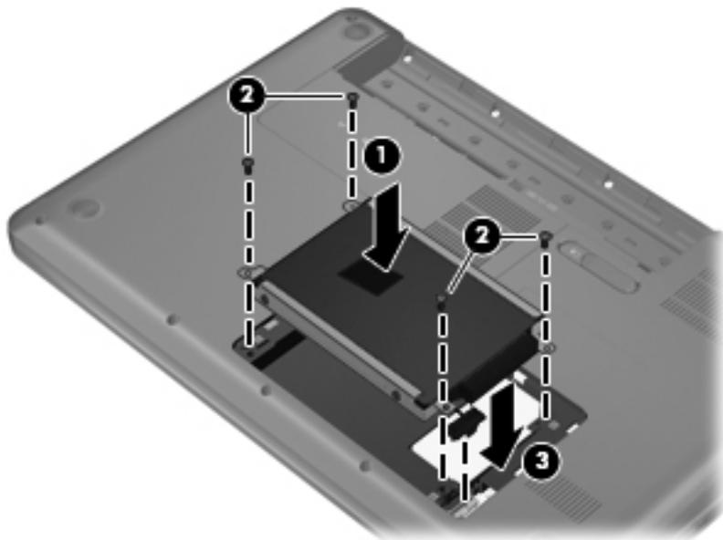
4. 將硬碟外蓋上的定位片對準電腦上的缺口 (1)。
