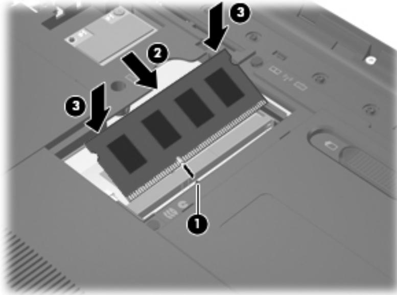
8. 將記憶體模組置放槽外蓋上的定位片對準電腦上的缺口 **(1)**。
