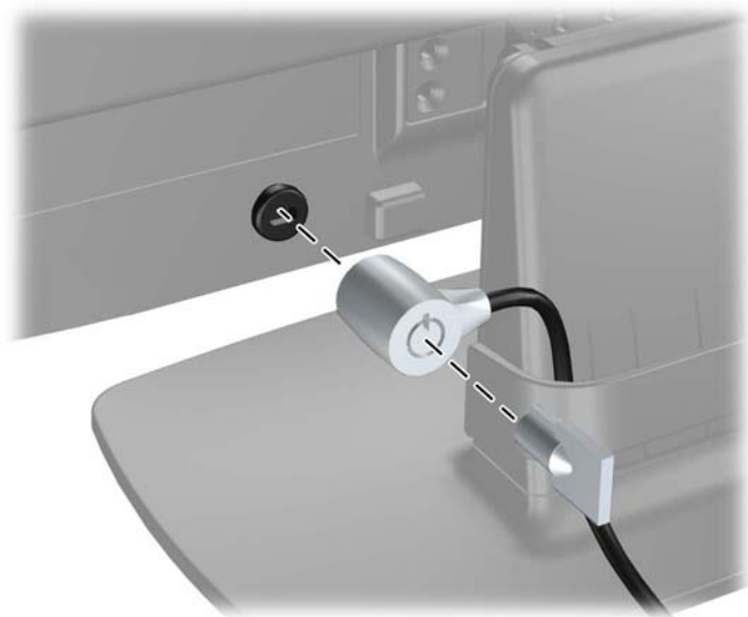
Figur 2-10 Montering af en kabellås
