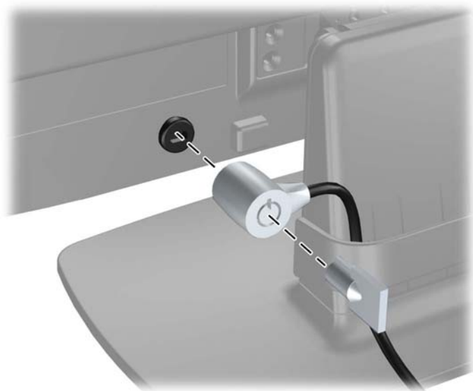
Figur 2-10 Installere en kabellås
