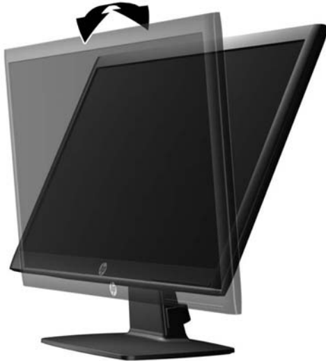
Figura 2-7 Inclinação do monitor
